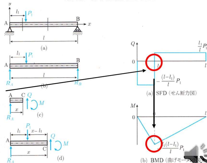
図 6.6 せん断力 Q と曲げモーメント M
