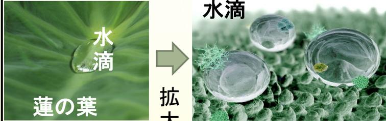
原理: 微小突起により水滴下面に空気 (ロータス(蓮の葉)効果)
